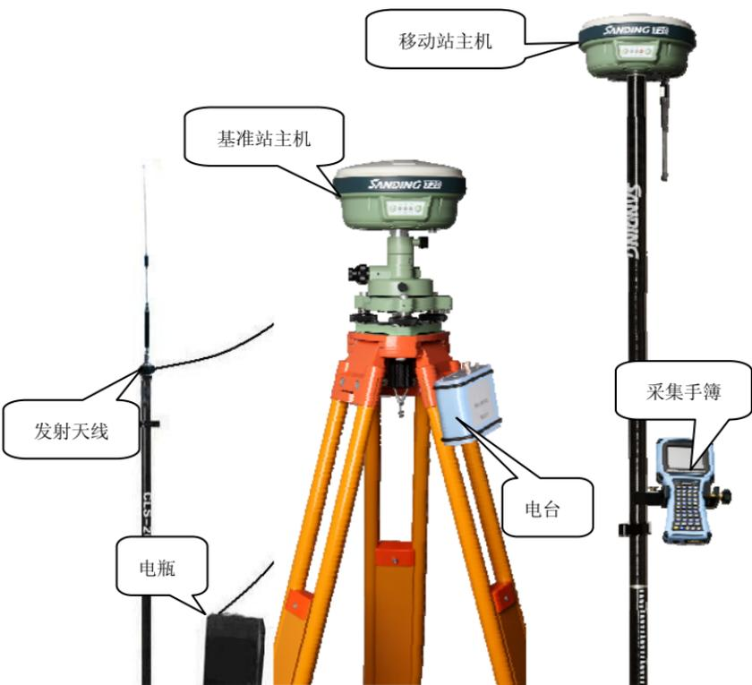
图 5-1 基准站和移动站的安装示意图
