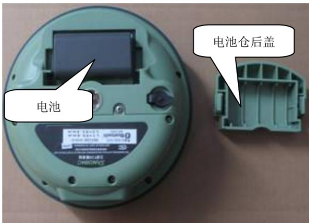
图 2-3-2 三鼎 T20 底部电池安装
