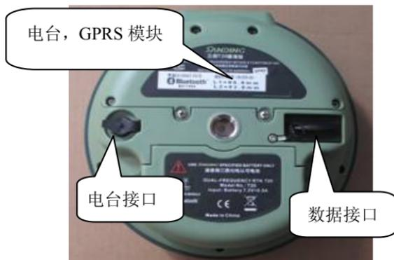
图 2-2 三鼎 T20 底部接口（移动站）
