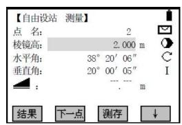
对准目标点按 F3 测存即可,然后按 F2 下一点进行目标点设置,然后再测量,对两个及以上的目标点设置测量好后在测量界面,按 F1 结果就可以显示测站点坐标
