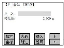
第一种方法,就是仪器里已经把目标点坐标输入到了仪器里面,只需要输入点名和棱镜高点确认完成设置。
